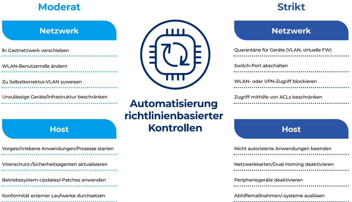
Abb. 1. Durchsetzung von Richtlinien im Netzwerk und auf Endgeräten mit nach und nach zunehmendem Automatisierungsgrad.
